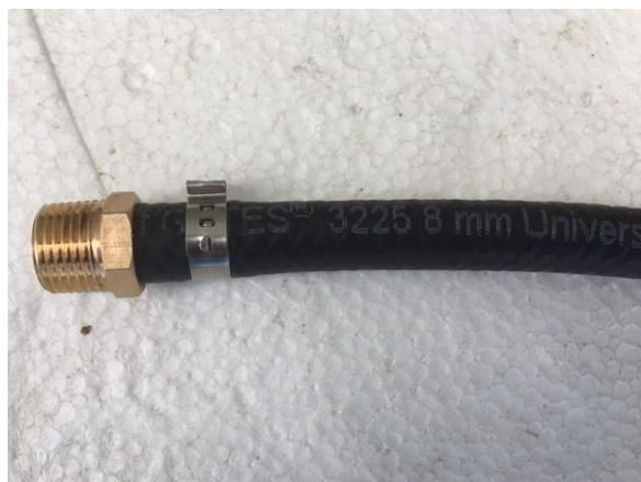
Bilde 4. Korrekt montert engangsklemme på slangestussen.
