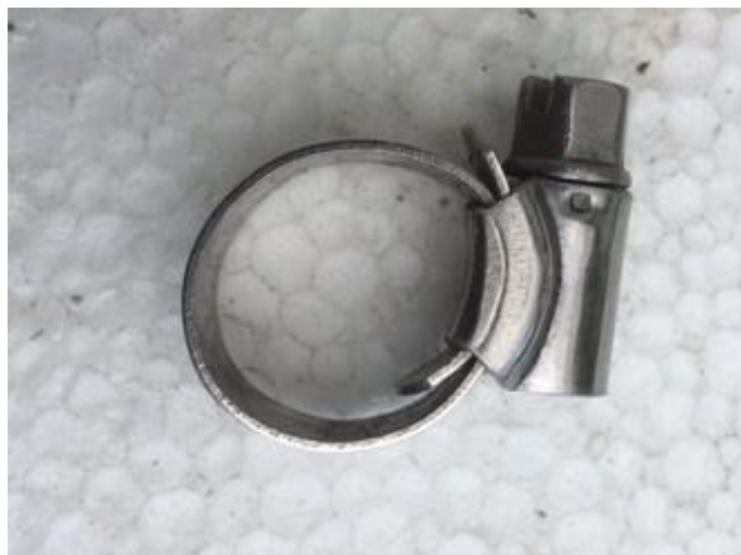
Bilde 1. Wormdrive – en type som ikke skal brukes i et luftfartøys drivstoffsystem.
