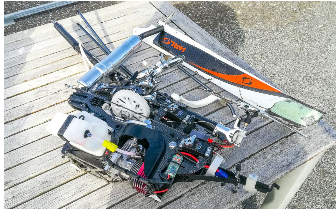
Faktisk hendelse: Helikopteret datt ned i en steinrøys uten kontroll på venstre swash-servo. Ingen skade annet enn på lommeboka som vi sier. Men den egentlige årsaken til slik "radiofeil" viste seg å være mangel på pre-flight sjekk. Jeg burde ha oppdagat skruen som var borte fra servohornet før dagens første tur.
