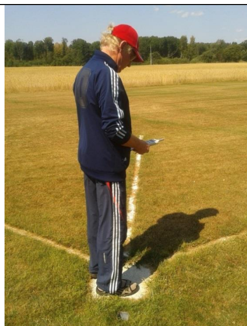
Lydmåler og modell ble holdt 1 meter over bakken i begge vindretninger for mest mulig konsistent resultat
