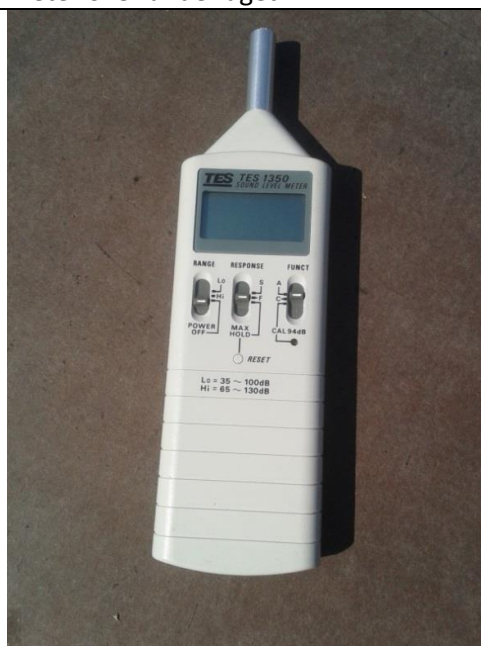
TES 1350 ble benyttet i «A-Lo» modus (35-100 dB, vektning A for frekvenser hørbar for det menneskelige øret). Instrumentet har en oppgitt nøyaktighet på \pm 2 dB og innebygget kalibrator.
