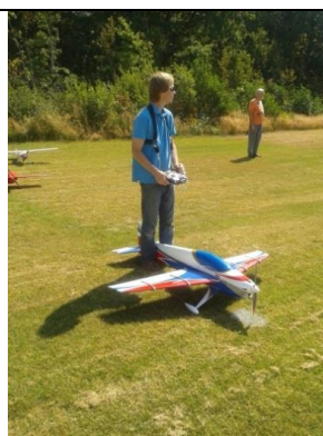
Måling foretas med modell på full gass. Målinger ble foretatt på bakkenivå (FAI-standard) og 1 meter over underlaget.
