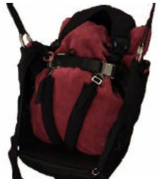
Seletøy med justerbar stabilitet i lårstroppene.
