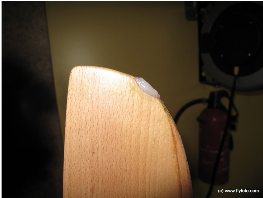
Bildet over viser et lite hakk fylt med 2 komponent epoxy lim
